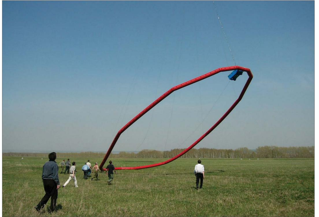
Специалисты СНИИГТМСа проводят испытания вертолетной разведочной платформы серии «Импульс»
